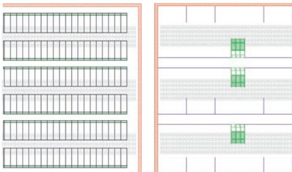
Простое переоснащение станков индивидуального содержания на станцию CallBack<sup>pro</sup>. Подача корма может быть, как правило, и дальше использована, при этом наполное пространство не требует внесения изменений.
