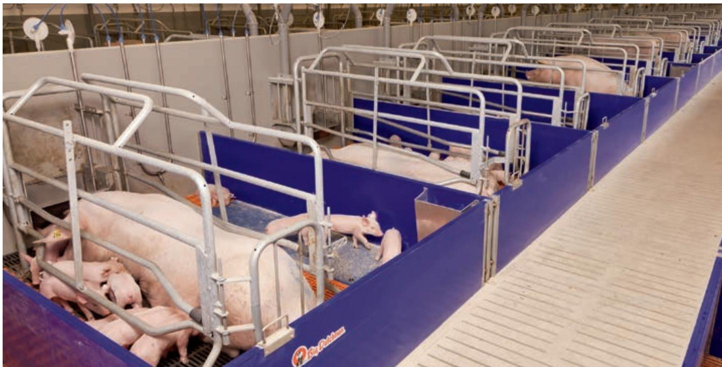
Станок с 4 опорами с чугунной решеткой под свиноматкой и плитой обогрева для поросят
