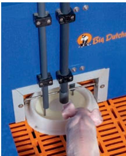
Датчик проверяет уровень корма в кормушке и передает информацию на 510pro
