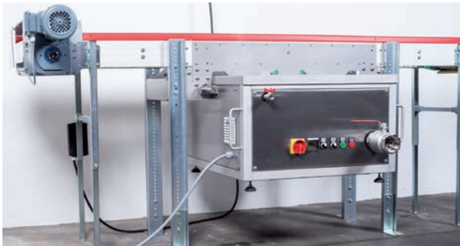
Компактный очистительный узел занимает меньше места и не требует установки отклоняющего устройства над транспортером
