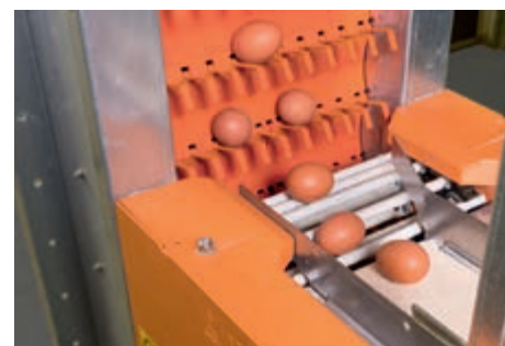
Передача яйца с продольного на прутковый транспортер с последующей транспортировкой на элеватор
