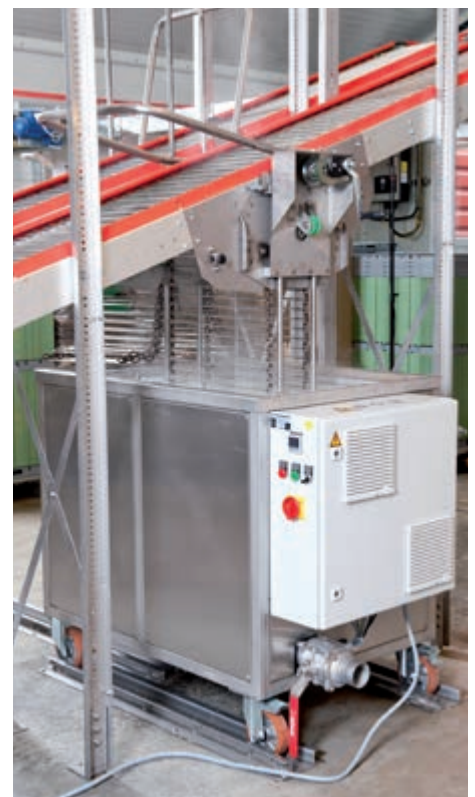
Очистительный узел для транспортера шириной не более 750 мм
